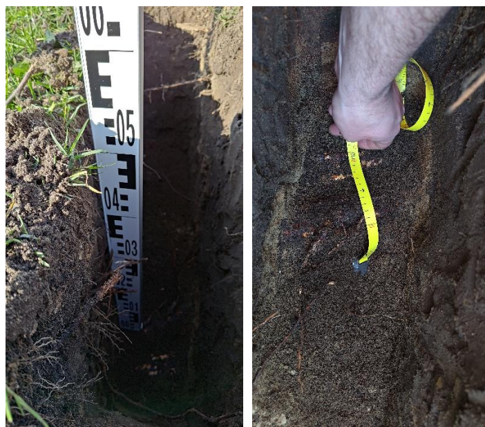
Afbeelding 8: GPO 1; proefsleuf op 2,3 meter afstand van de boom.
