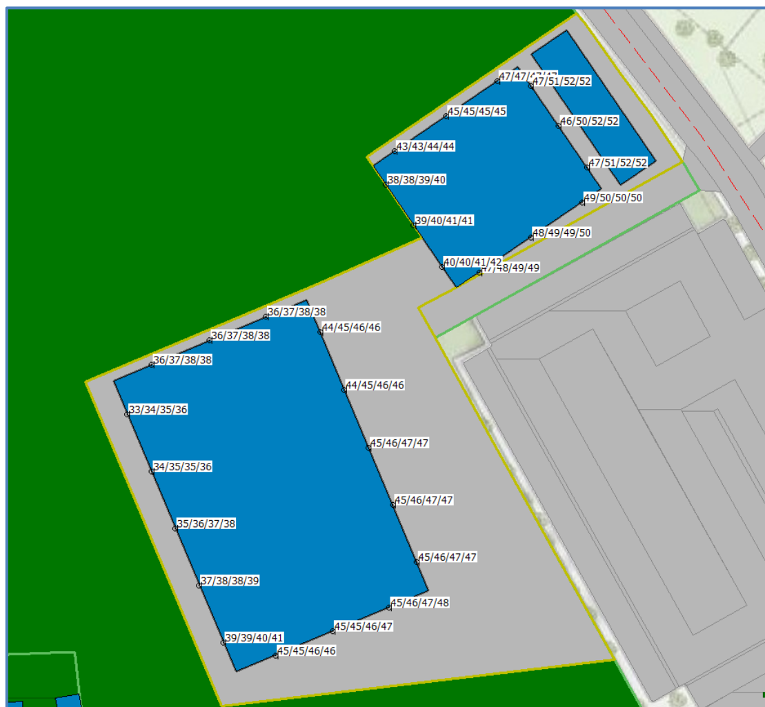
Afbeelding 8. Geluid L_{den} Gemeentewegen Berekend geluid op een hoogte van 3,0 ; 6,0 ; 9,0 en 12,0 meter
