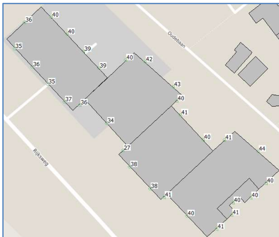
Afbeelding 7.2 Geluid L_{den} Gemeentewegen Berekend geluid op een hoogte van 5,0 meter
